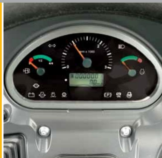
**La instrumentación digital** se encuentra incorporada elegantemente en el cuadro de mandos con pantalla anti-reflejos e indica contemporáneamente las revoluciones del motor, las revoluciones de la toma de fuerza y la velocidad de avance del tractor.
